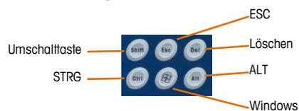
**Abbildung 2-5: IND970-15 Windows-Funktionstasten, Detail**
