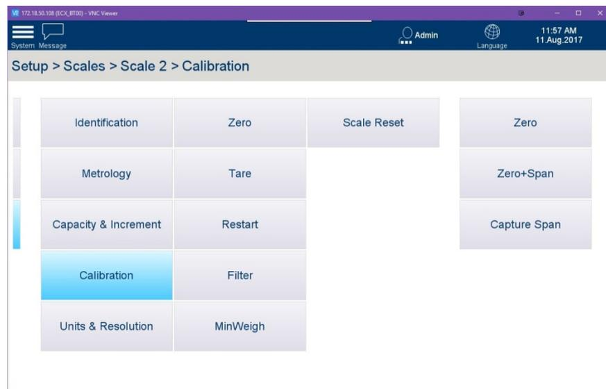
**Abbildung 3-23: Waagenkalibrieroptionen, nicht-IDNet-Waagen**
