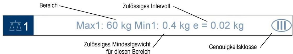
**Abbildung 2-23: Messtechnische Anzeige eines zugelassenen Terminals**
