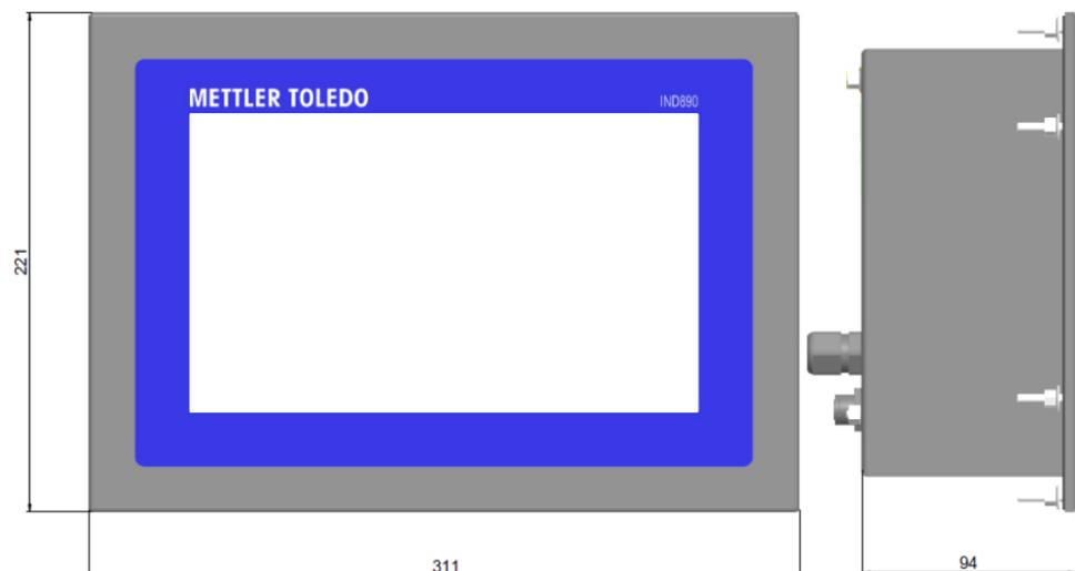
Abbildung 1-2: Abmessungen des IND930 für den Schaltschrankbau
