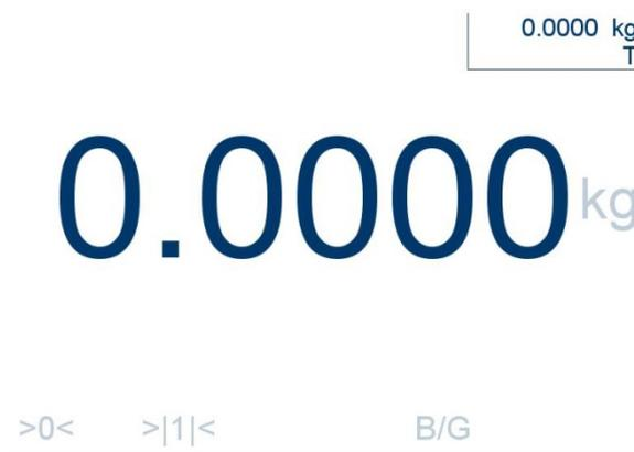
**Abbildung 3-45: Taraanzeige bei Einstellung der Zusatzanzeige auf „Immer tarieren“**
